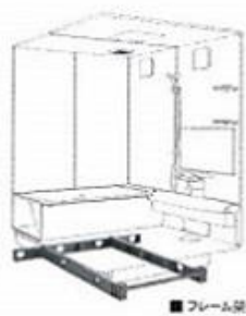
頑丈さのみみっは浴室の重 さをしっかり支えるフレーム 構造の架台。
