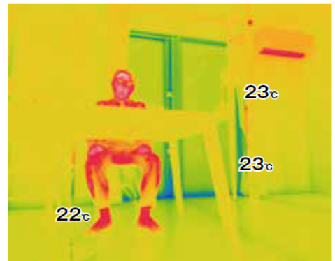
【断熱リフォーム後】HEAT20 G2グレード
